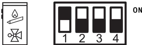
Fig. 20 DIP-Schalterstellung für Funktionsmodul Pufferladung/Umschaltung
